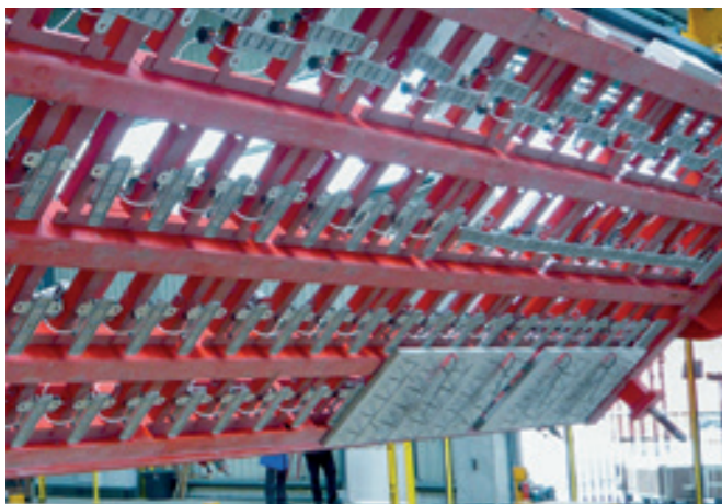
VacuStation SWS-2500KG Vakuum-Wendevorrichtung für die Herstellung doppelagiger Betonwände.
