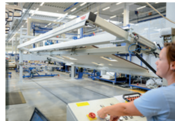
VacuStation SWS-360E-250KG Stationäre Wendeanlage mit pneumatischen Verstellmöglichkeiten für die Vormontage von Wohnmobildächern.
