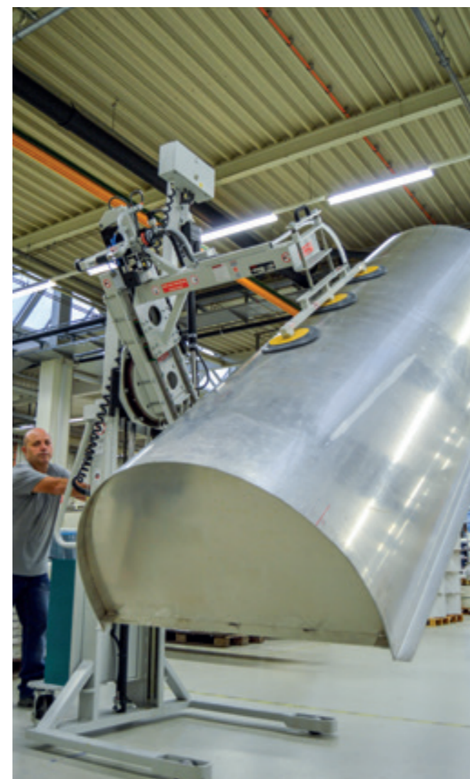
MobiLift ML-180E-250KG mit elektrischer Hub- und Schwenkvorrichtung für die Handhabung von Formelementen.
