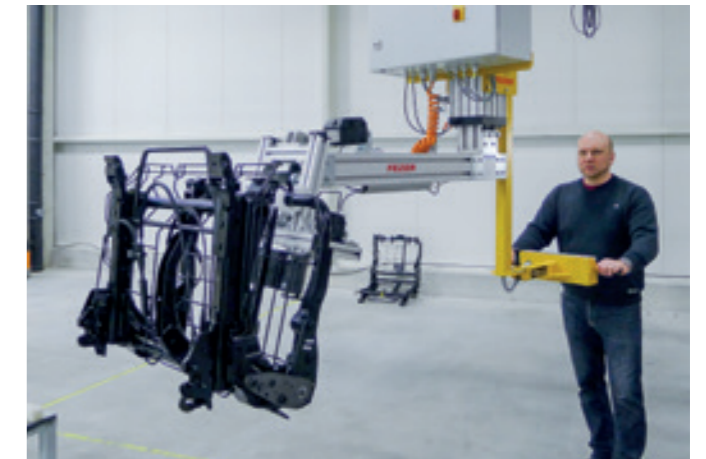
LiffFix LF-100KG Starres Hubsystem LiffFix für die Handhabung von Stahl-Sitzgruppen für die Vormontage.
