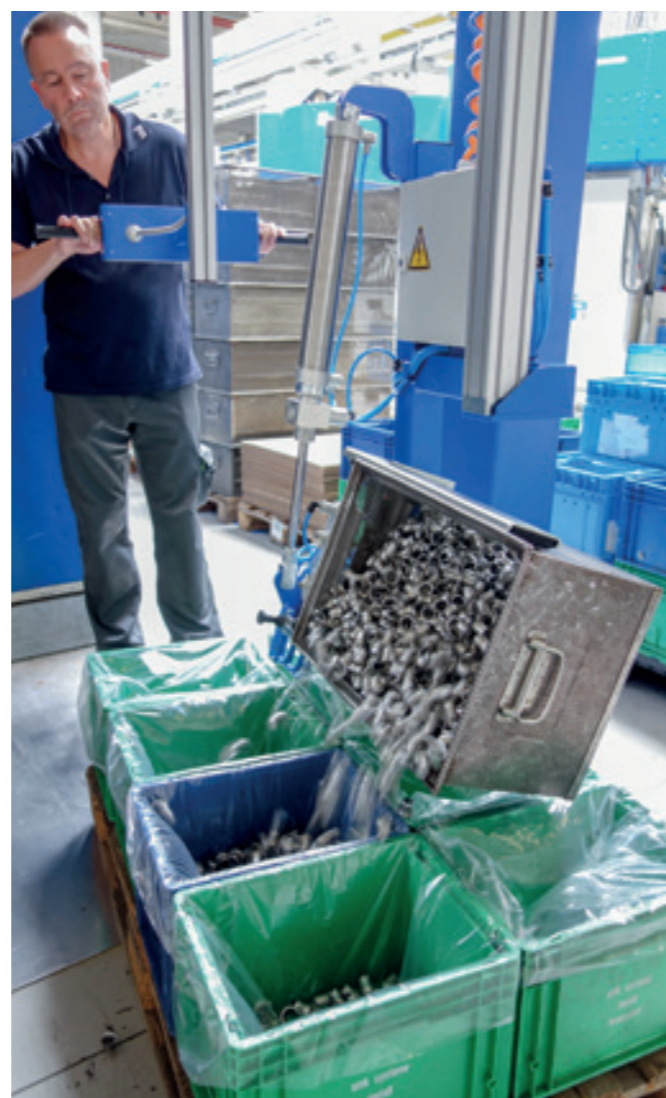
LiftFix LF-1200-60KG Starres Hubsystem mit pneumatischer Schwenkvorrichtung für das Entleeren kleiner Gitterboxen.
