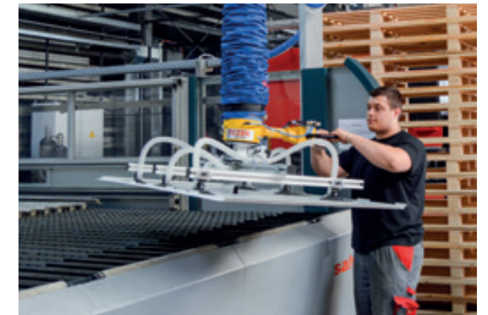
VacuPowerLift VPL-80KG Vakuum-Schlauchheber für die Zuführung von Blechen an eine Laser-Schneidanlage.
