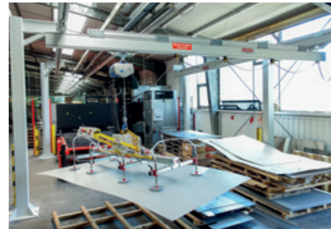
Aluminium-Hängebahnsystem HBS-DB-TEL-500KG mit eigenem Stahlbau und verstärkter Brücke für erhöhte Tragfähigkeit.
