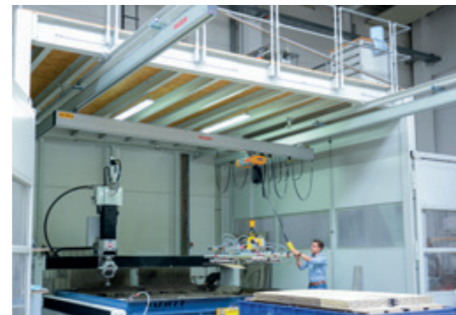
Aluminium-Hängebahnsystem HBS-EB-250KG mit Einzelbrücke und auskragendem Stahlbau für stützenfreies Herausfahren von Bauteilen.
