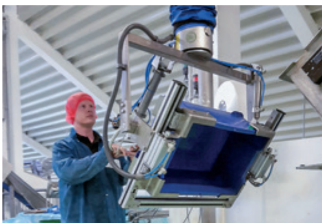
VacuPowerLift VPL140-50KG Mit pneumatischer Schwenkvorrichtung für das Entleeren von Kanistern.
