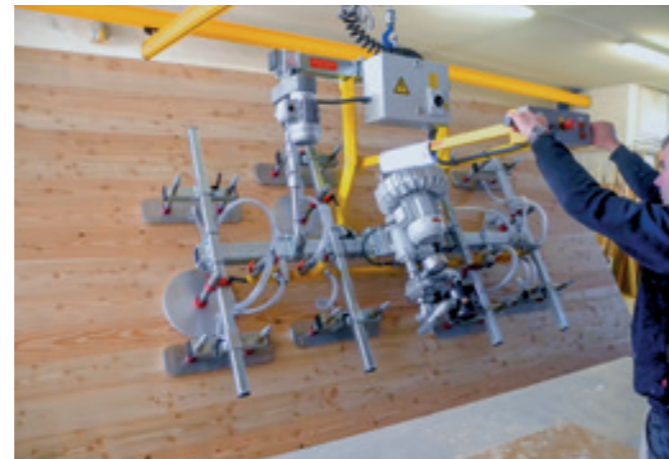
VacuPoro VP-90E-250KG Schwenkbares Hebegerät für die Handhabung von Tischler- und Spanplatten.
