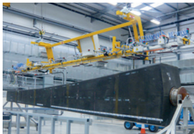
Vakuum-Lastaufnahmemittel VLM-180E-TEL-500KG Teleskopierbarer 180°-Wender für Flugzeugelemente aus Kohlefaser-Verbundwerkstoffen.
