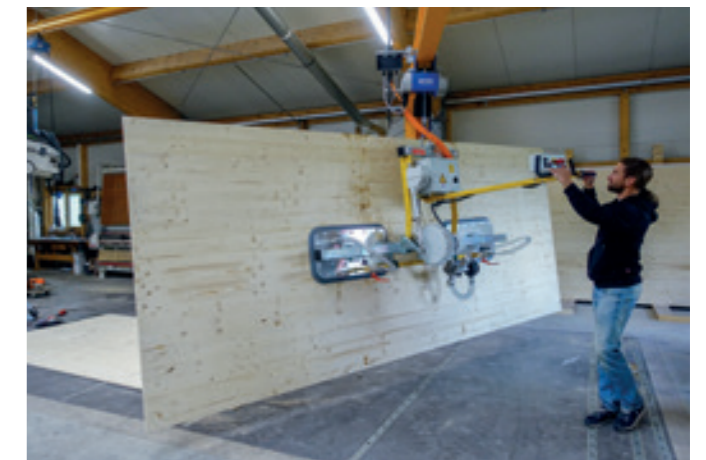
VacuPoro VP-90E-250KG Umsetzen von Tischlerplatten aus einem stehenden Regalsystem an eine Aufteilsäge.
