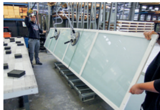
VacuBoyVario VBV-125KG für das Umsetzen und Aufrichten von Windowelementen mit Längen bis zu 4.000 mm.
