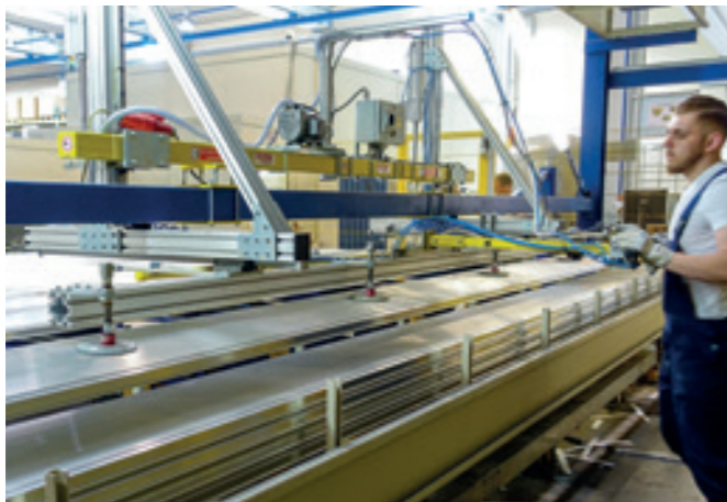
LiftFix LF-125KG Pneumatisch gesteuertes, starres Hubsystem für die Zuführung von Aluprofilen an eine Stanzmaschine.
