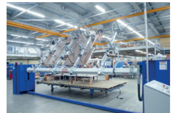
VacuStation SWS-180E-250KG Stationäre Wendeanlage mit elektrischer Höhenverstellung für Bodenelemente von Wohnmobilen.
