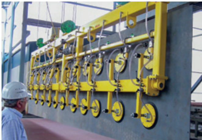
VacuGiant VG-90H-8000KG Hydraulisch schwenkbare Schwerlasttraverse für 8.000 mm lange Bleche in einem Rungenlager.
