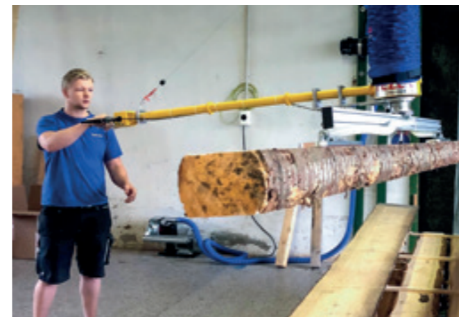
VacuPowerLift VPL-100KG für die Handhabung von sägerauen Holzbohlen.
