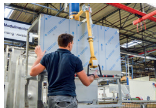
VacuPowerLift VPL-80KG Handhabung von großen Blechgehäusen mit einem Schlauchheber mit abkröpfbaren Bediengriff.
