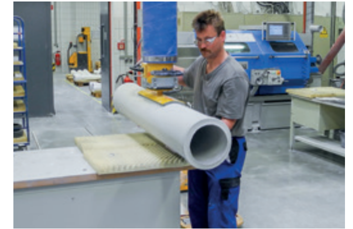
VacuPowerLift VPL-80KG Schlauchheber mit Spezialgreifer für das Umsetzen von Betonrohren.
