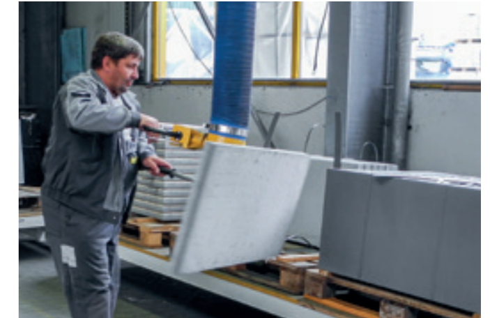
VauPowerLift VPL-90M-60KG Vakuum-Schlauchheber mit manueller Schwenkvorrichtung für die Handhabung von Steinelementen.
