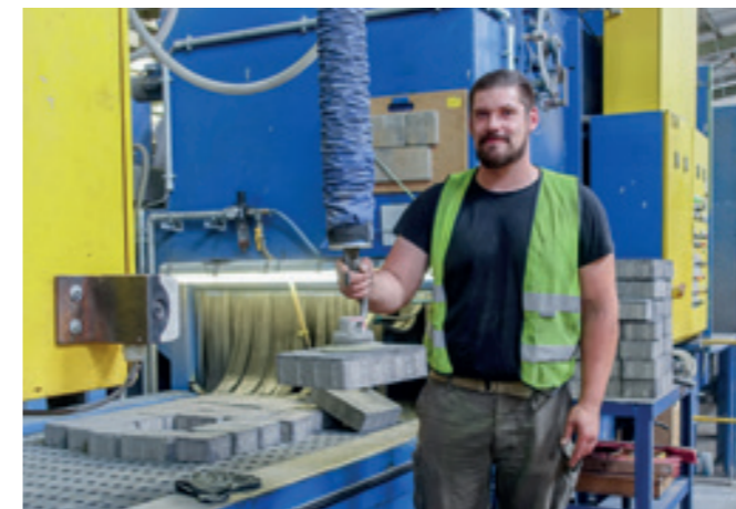
VauQuickLift VPQ120-40KG Handhabung von Pflastersteinen mittels Vakuum-Schlauchheber.
