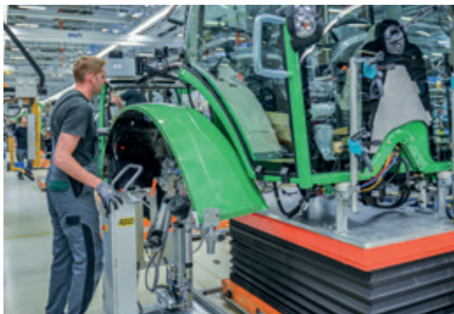
VacuStand VS-I-125KG Mobiler Arbeitsständer für das Andocken und die Endmontage von Kotflügeln an eine FTS-Station.
