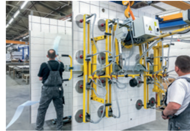
VacuBoy VB-90E-125KG Schwenkbare Vakuumheber für die Handhabung vorgefließter Wandelemente.
