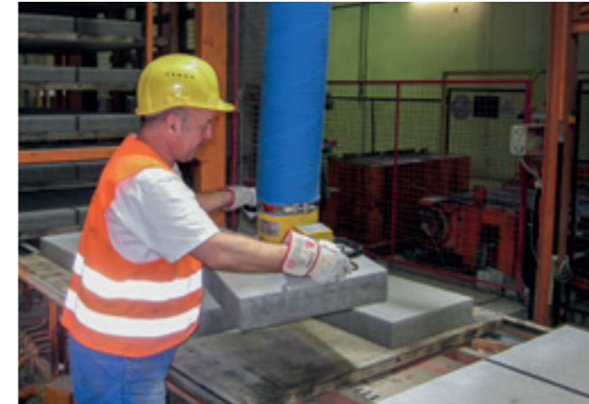
VauPowerLift VPL-60KG Vakuum-Schlauchheber für die Handhabung von Pflastersteinen.
