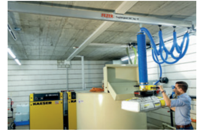
Aluminium-Hängebahnsystem HBS-EB-60KG mit direkter Deckenabhängung und aufgebockter Einzelbrücke für niedrige Bauhöhe.
