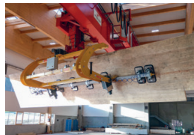
VacuPoro VP-180E-1000KG Vakuumheber für das Wenden von 8.000 mm langen Massivholzplatten.
