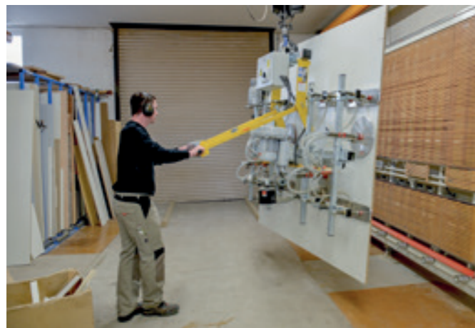
VacuPoro VP-90E-250KG Schwenkbares Hebegerät für die Beschickung einer stehenden Platten-Aufteilsäge.
