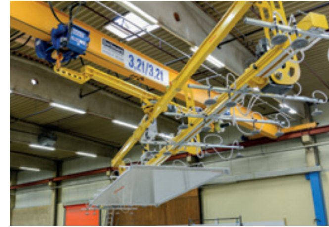
VacuGiant VG-90E-360E-2500 KG Elektrisch schwenk- und drehbare Vakuumtraverse für die Handhabung von LKW Seiten- und Dachelementen.
