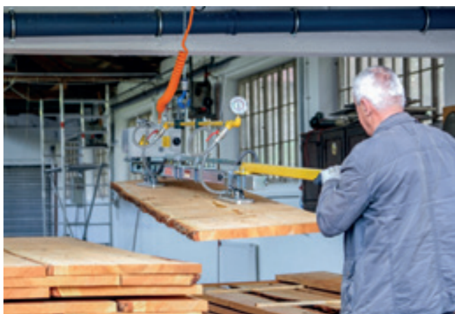
VacuWood VWB-250KG Umschichten von sägerauen Holzbohlen mittels eines Bohlenhebergerätes.
