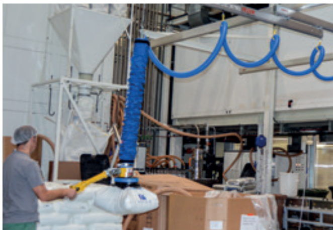
Aluminium-Hängebahnsystem HBS-EB-TEL-250KG Mit teleskopierbarer Einzelbrücke und Schlauchheber für die Handhabung von Säcken.
