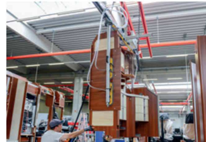
VacuBoyVario VBV-100KG Handhabung von Einbauschränken in der Vormontage von Wohnmobileinrichtungen.
