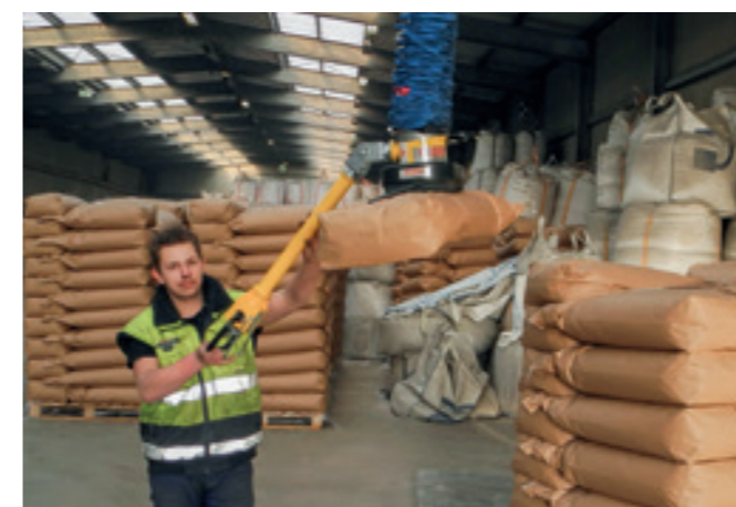
VacuPowerLift VPL-60KG Vakuumschlauchheber für das Um- setzen von Papiersäcken.
