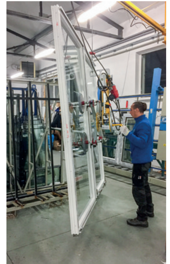
VacuBoyWindow VBW-125KG Vertikaler Glasheber für das Umsetzen und Drehen von Windowelementen.
