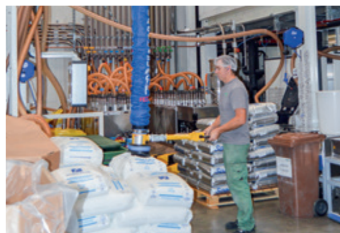
VacuPowerLift VPL-60KG Schlauchheber mit gelenkigem Bedi- egriff für die Handhabung von Kun- stsstoffsäcken.
