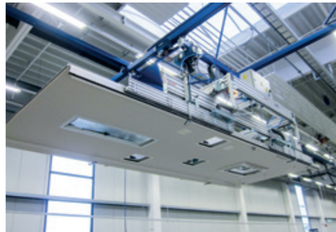
Vakuüm-Lastaufnahmemittel VLM-250KG Handhabung von Wohnmobildächern nach der Vormontage.
