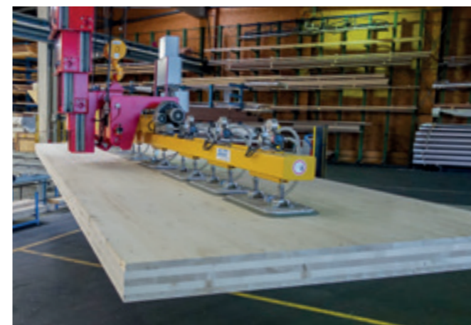
VacuPoro VP-3000KG Vakuumheber an einer starren Hubachse für das Handling massiver Vollholzplatten.
