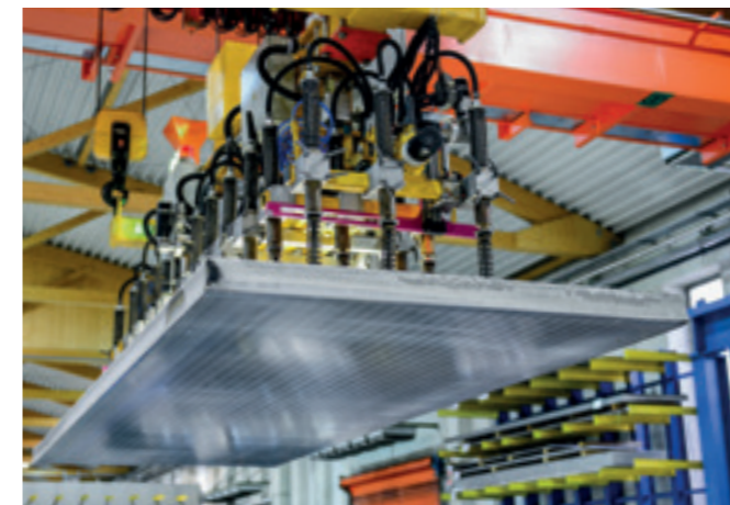
VacuGiant VG-6000KG Horizontales Handling von Aluminiumplatten mit Längen von 8.000 mm in einem Walzwerk.
