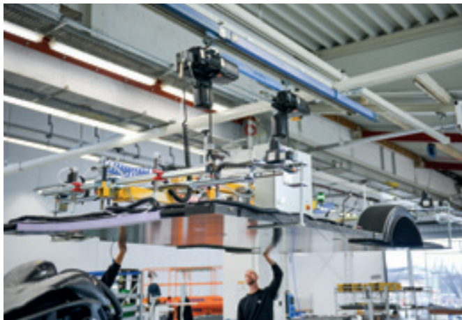
VacuBoy VB80-150KG Transport von Bodenelementen für Wohnmobile mit elektrischen Untergreifern als zusätzliche Sicherung.
