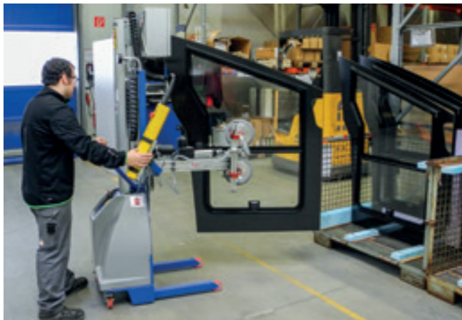
Mobilift ML-90E-45KG Mobiler Arbeitsständer mit elektrischem Schwenkmechanismus für Windowelemente.
