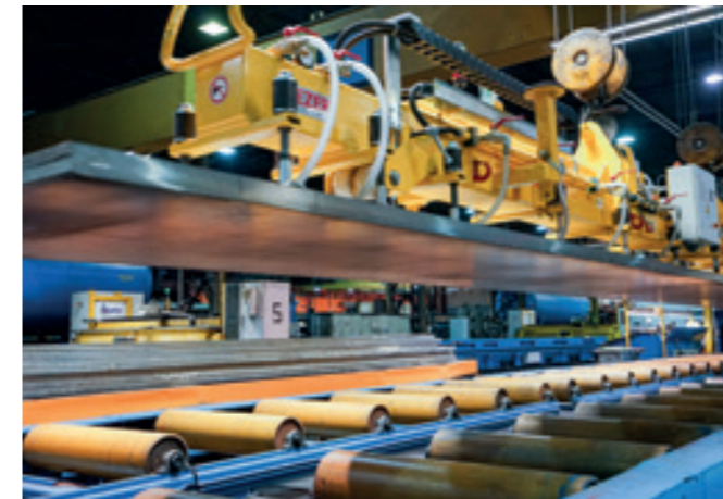
VacuGiant VG-TEL-6000KG Manuell ausziehbare Vakuumtraverse für Blechlängen von 6.000-12.000 mm.
