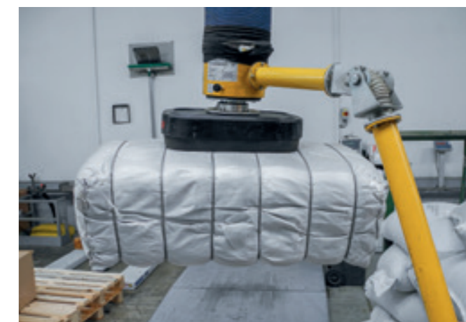
VacuPowerLift VPL-60KG Handhabung von mit Seilen umreiftten Kunstsstoffsäcken.
