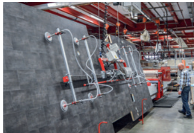
VacuBoy VB-90E-250KG Hebegerät mit Krananlage für die Handhabung von Bodenelementen.
