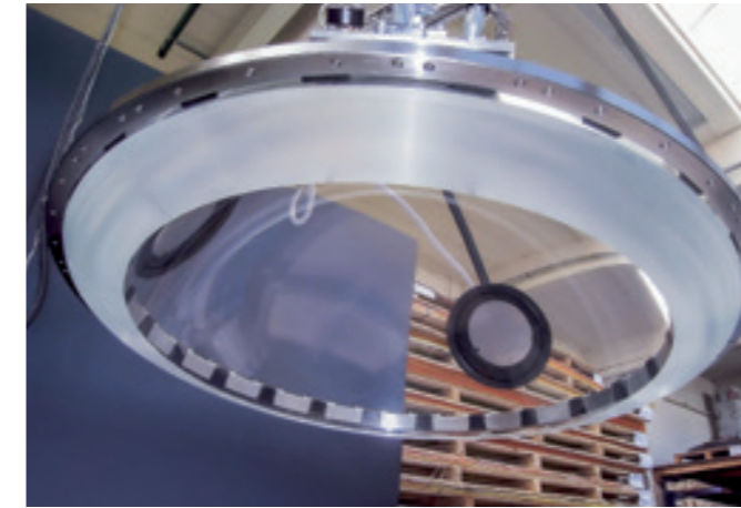
VacuBoyVario VBV-500KG Hebegerät zur Handhabung der Sichtkuppel eines U-Boots zu Wartungszwecken.
