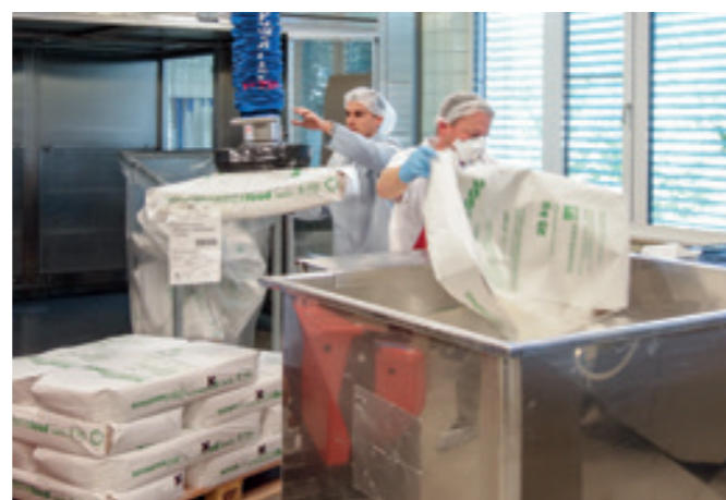
VacuPowerLift VPL-60KG Vakuum-Schlauchheber in Edelstahl- ausführung für die Handhabung ein- lagiger Papiersäcke.
