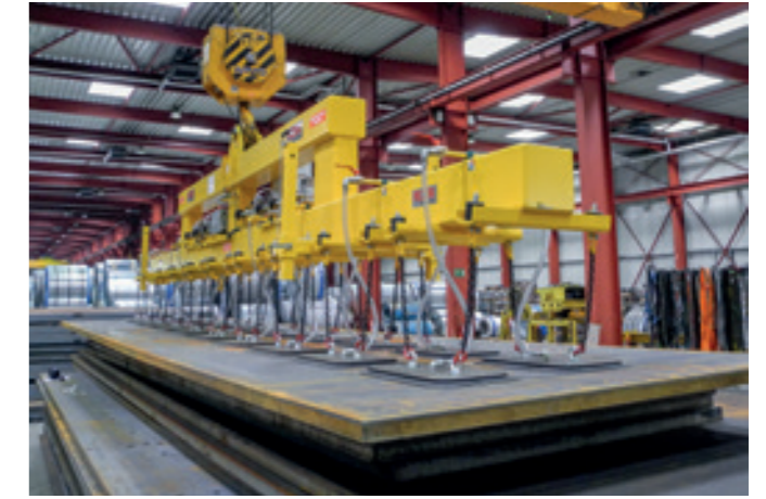
VacuGiant VG-25000KG Schwerlasttraverse für das horizontale Handling großformatiger Bleche bis 16.000x3.500x300 mm.
