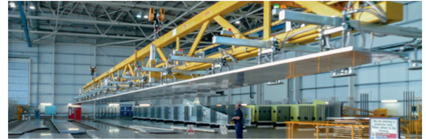
VacuGiant VG-1500KG 36.000 mm langer Vakuumheber für die Handhabung von Rohteil-Aluplatten für die Produktion von Tragflächenelementen für den Airbus A380.
