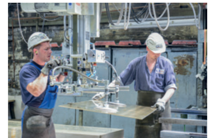
LiftFix LF-250KG Starres Hubsystem mit Drehkranz für die Beschickung einer Kantpresse mit Kupferblechen.
