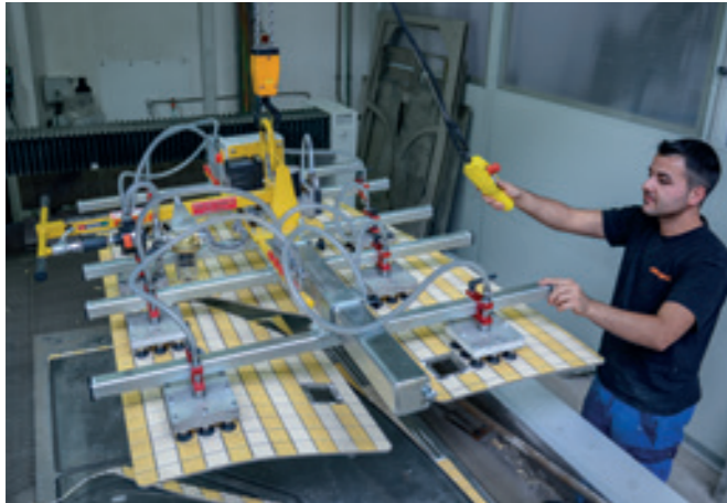
VacuBoy VB-ACCU-125KG Netzunabhängiger Vakuumheber mit Wechselakku für die Handhabung von vorgefließten Wandelementen.
