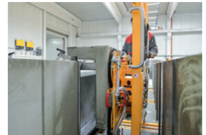
Vakuum-Lastaufnahmemittel VLM-VERT-180E-800KG Entnahme von Doppel-L-Stein Elementen aus der Produktionsform.
