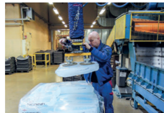
VacuPowerLift VPL-60KG mit speziellem Doppel-Sauggreifer für die Handhabung von Kautschukballen.
