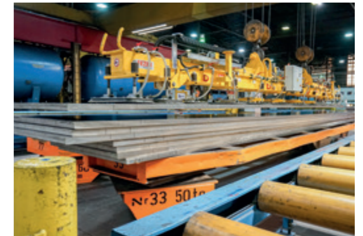
VacuGiant VG-TEL-8000KG Manuell teleskopierbare Vakuumtraverse zum Umsetzen von bis zu 14.000 mm langen Alublechen.
