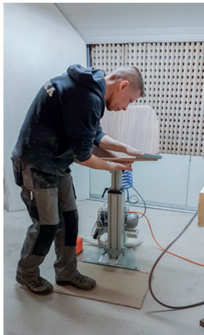
VacuStand VS-60KG mit manueller Höhen-, Dreh- und Schwenkvorrichtung für die Bearbeitung von Sitzstühlen.
