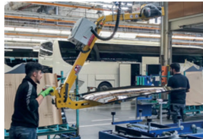
VacuBoy-180E-60KG 180°-Wender in niedriger Bauweise für die Handhabung von Glasscheiben.
