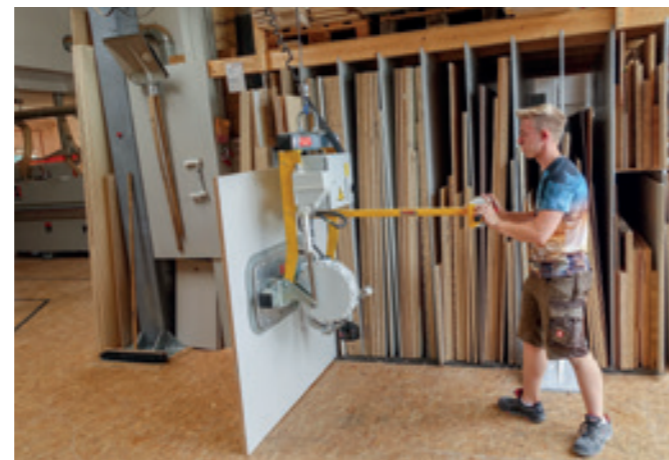
VacuPoro VP-90E-125KG Handhabung von Holzplatten aus einem stehenden Plattenregal-System.
