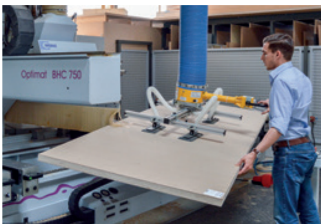
VacuPowerLift VPL-125KG Beschickung einer CNC-Holzbearbeitungsmaschine mit porösen Holzelementen
