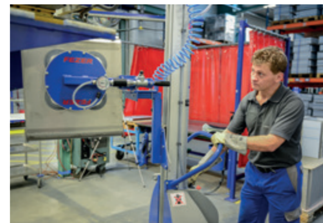
Mobilift ML-60KG Mobiler Arbeitsständer mit Höhenverstellung, für die Zuführung von Blechteilen an eine Schweißstation.
