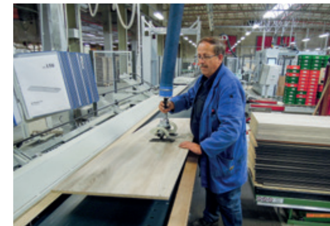
VacuQuickLift VQL-45KG Umsetzen von Tischlerplatten mittels eines Vakuum-Schlauchhebers.
