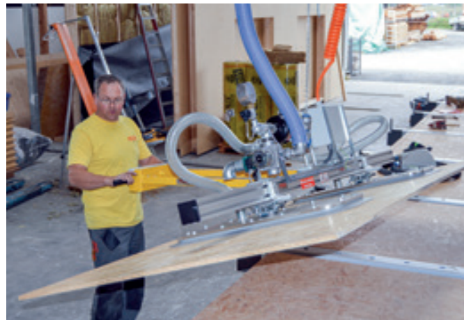
VacuPoro VP-250KG Beschicken einer CNC-Bearbeitungsmaschine mit porösen OSB-Platten.
