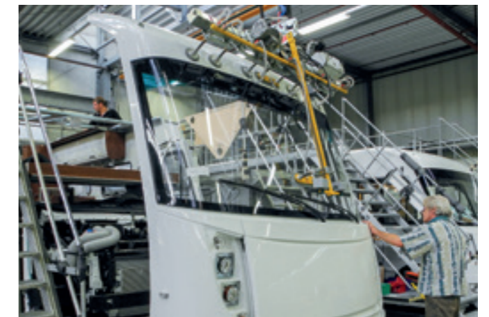
VacuBoy VB-VERT-125KG Vertikales Hebegerät für die Handhabung von Frontelementen in der Endmontage.
