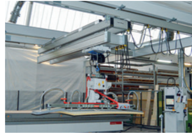
Aluminium-Hängebahnsystem HBS-DB-TEL-250KG mit Stahlbau und teleskopierbarer Doppelbrücke in geschlossener Kastenform.
