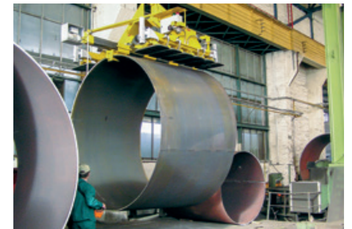
Vakuum-Lastaufnahmemittel VLM-6000KG Kombitraverse für die Handhabung von Blechen und Rohren mittels Vakuum- und Klammertechnik.
