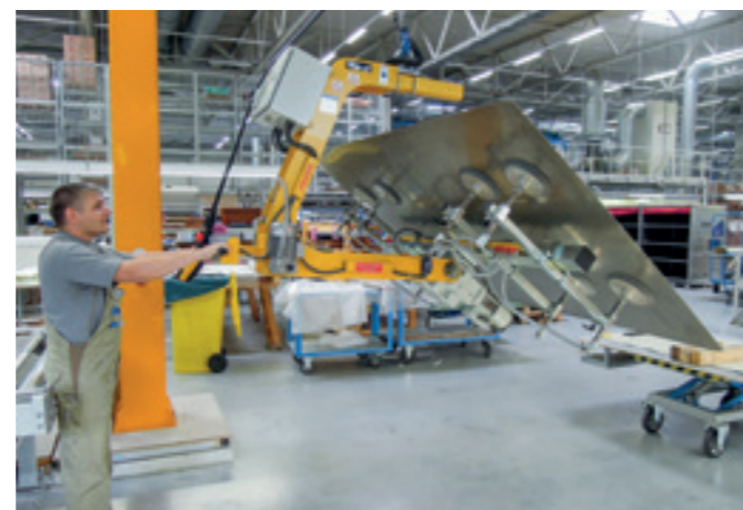
VacuBoy VB-180E-250KG 180°-Wendegerät für Stahlbleche.
