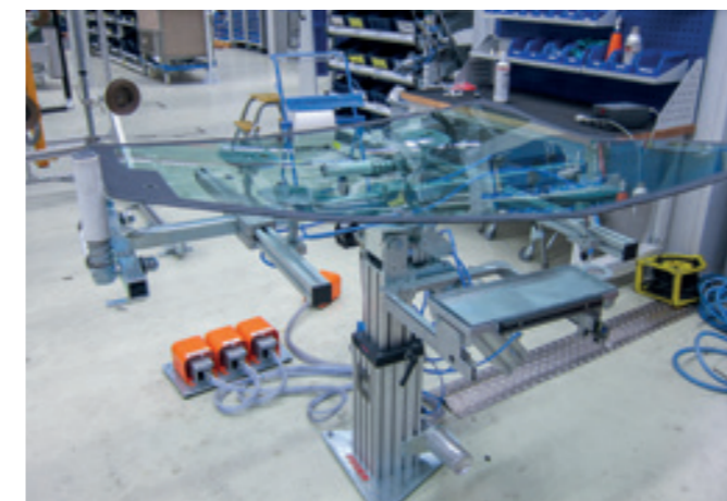
VacuStand VS-80KG Stationärer Arbeitsständer mit pneumatischer Höhen- und Schwenkvorrichtung für Endmontage von Traktoren-Seitenscheiben.
