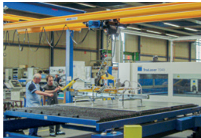
Stahl-Hängebahnsystem HBS-EB-500KG Doppelbrücke mit Spannweite von 8.000 mm, Kettenzug und Vakuumheber.
