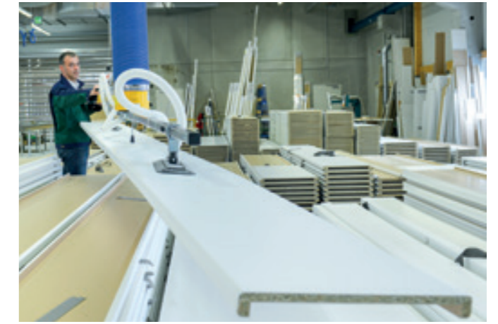
VacuPowerLift VPL-80KG Handhabung von bis zu 6.000 mm langen, beschichteten Holzarbeitsplatten.
