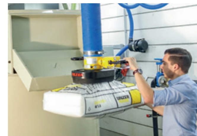
VacuPowerLift VPL-60KG für die Befüllung eines Vorratsbehäl- ters mit Kunstsstoffgranulat.
