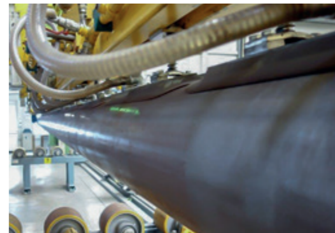
Vakuum-Lastaufnahmemittel VLM-3000KG Vakuumtraverse an einem Automatikkrane für Rohre bis 6.000 mm Länge.
