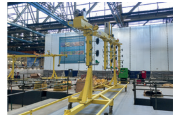
Vakuum-Lastaufnahmemittel VLM-VERT-750KG Vakuumtraverse mit mobilem Transportgestell für die Handhabung von Tragflächenelementen.
