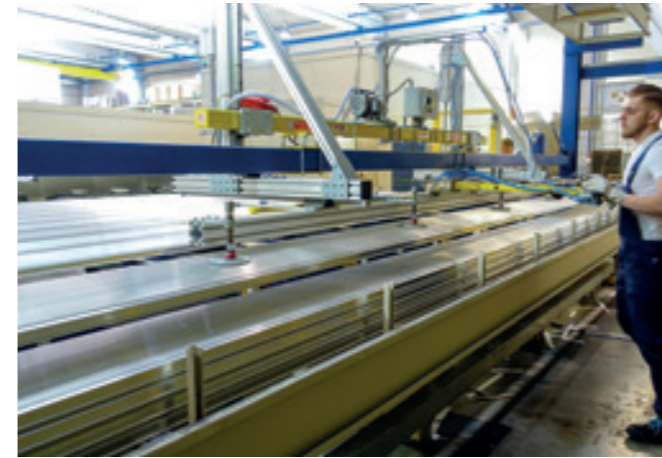
LiftFix LF-125KG Starres Hubsystem mit pneumatischen Hub für die Zuführung von Aluleisten an eine Säge.
