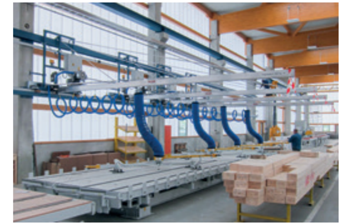
Aluminium-Hängebahnsystem HBS-4ALK-250KG Vier Auslegerkrananlagen mit je einem eigenen Fahr-antrieb und mitfahrenden Gebläse für Schlauchheber.
