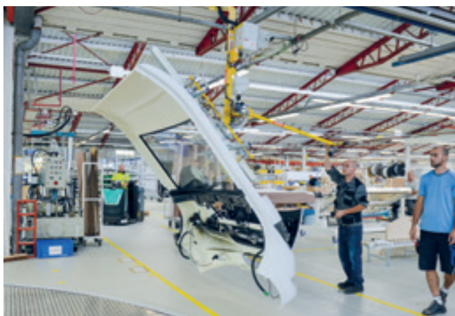
VacuBoy VB-90E-125KG Schwenken von komplett vormontierten Frontelementen
