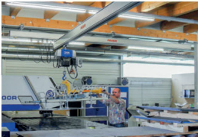
Aluminium-Hängebahnsystem HBS-EB-250KG Mit Einzelbrücke und Kettenzug für die Handhabung von Stahlblechen.
