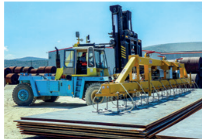
VacuGiant VG-SG-12000KG Vakuumtraverse für Gabelstaplerbetrieb im Außenbereich mit Heizsystem und eigenem Stromgenerator.
