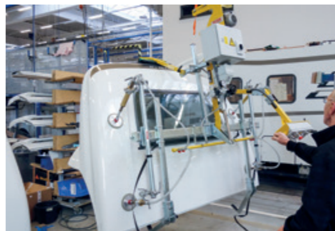
VacuBoy VB-90E-150KG Handhabung von Alkoven-Aufbauten um 90°.
