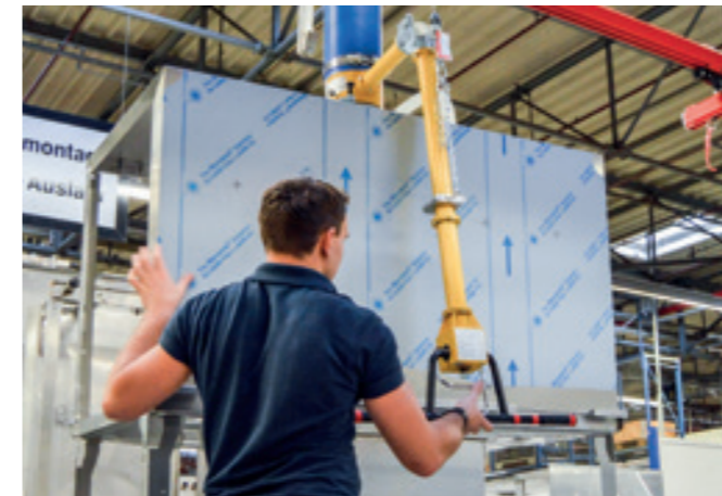
VacuPowerLift VPL-60KG Vakuum-Schlauchheber mit abschwengbaren Bediengriff für Stahlboxen.
