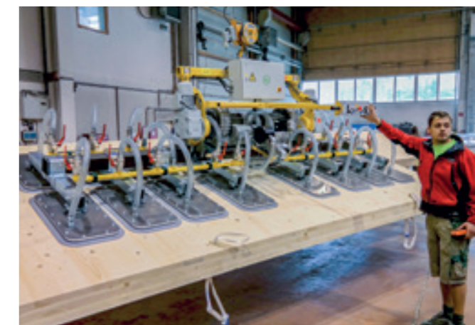
VacuPoro VP-90E-1500KG Vakuumheber für das Schwenken von 8.000 mm langen Massivholzplatten.
