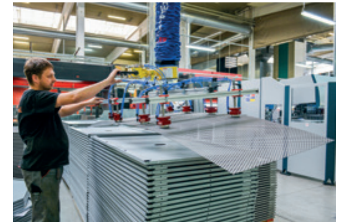
VacuPowerLift VPL-60KG Vakuum-Schlauchheber mit pneumatisch angesteuerten Magnetgreifern für Lochbleche.
