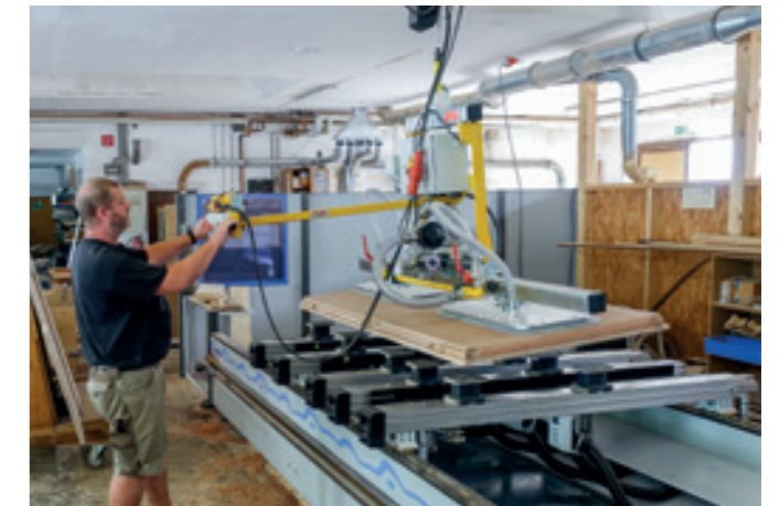
VacuPoro VP-90E-250KG Handhabung von Türelementen an einer CNC-Fräsmaschine.
