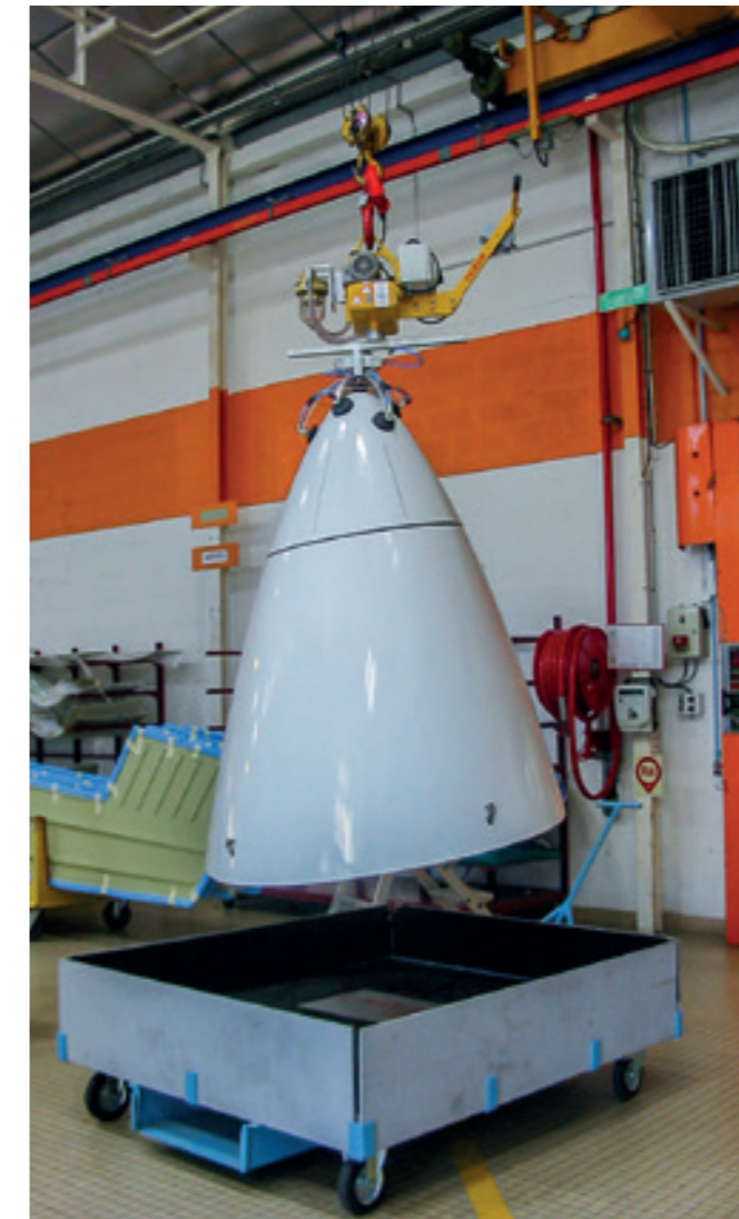
VacuBoyMini VBM-250KG Handhabung komplett montierter Flugzeug-Bugelementen.
