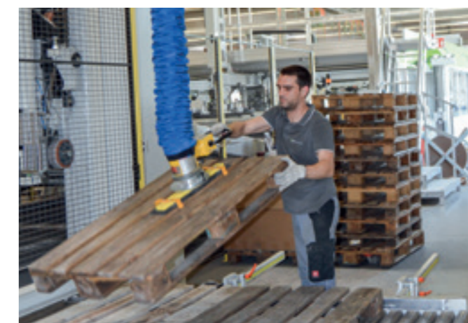
VacuPowerLift VPL-60KG mit Spezialausgreifer und Zentriervorrichtung für das Umsetzen von Euro-Paletten.
