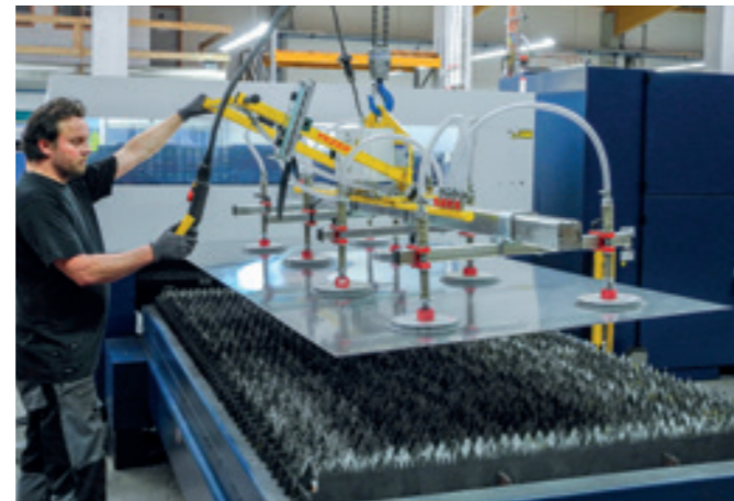
VacuBoy VB-500KG Vakuumheber für die Beschickung einer Laserschneidanlage mit Großformatblechen.
