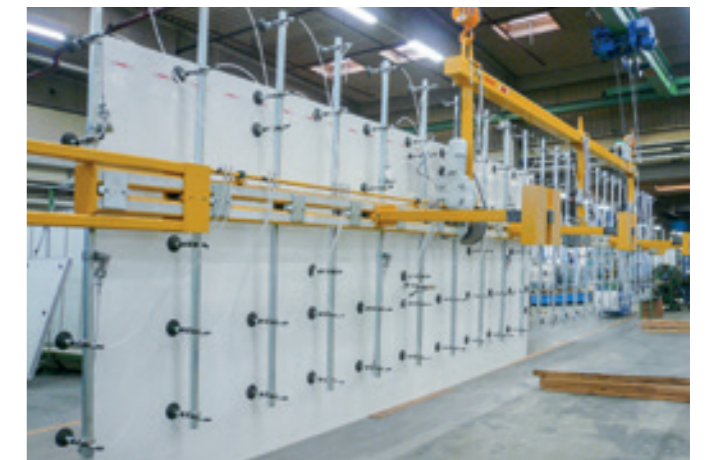
VacuGiant VG-90E-750KG Beidseitig schwenkbare Vakuumtraverse für bis zu 13.000 mm langen LKW-Seitenteilen.
