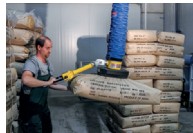
VacuPowerLift VPL-60KG Vakuumschlauchheber für die Hand- habung von zweilagigen Papiersäcken.
