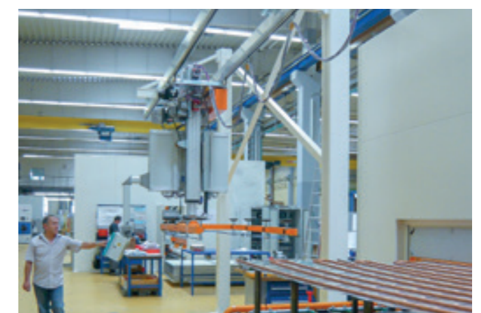
Aluminium-Hängebahnsystem HBS-DB-LF-100KG mit Stahlbau, starrem Hubsystem und elektrischen Reibradantrieb im halb automatischen Betrieb.
