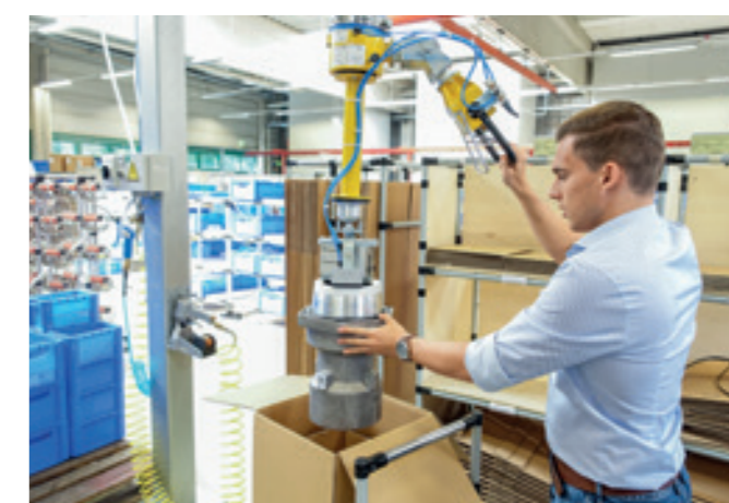
VacuPowerLift VPL-60KG mit pneumatischer Greifzange für das Verpacken von Guss-Formteilen.
