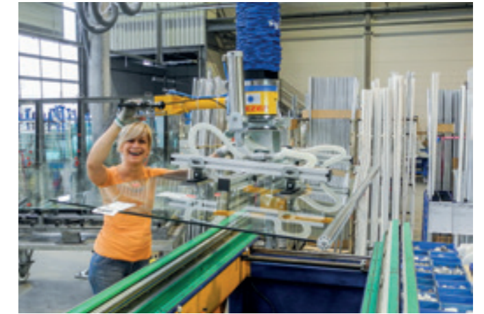
VacuPowerLift VPL180-90P-80KG Schlauchheber mit pneumatischer Schwenkvorrichtung für Glasscheiben.
