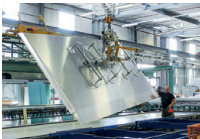
VacuBoy VB-90E-250KG Schwenkbares Vakuumgerät für die Handhabung von großformatigen Blechen.
