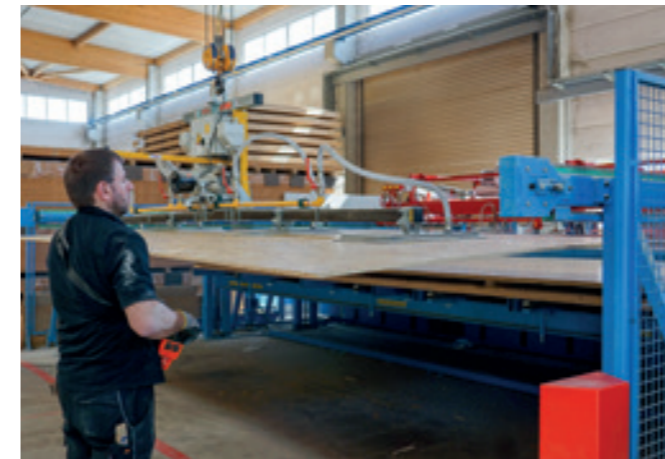
VacuPoro VP-90E-500KG Schwenkbares Hebegerät für die Beschickung einer CNC-Holzbearbeitungsanlage.
