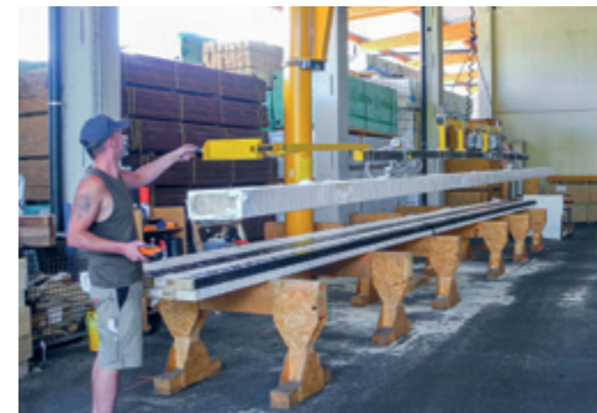
VacuWood VWLB-500KG Handhabung von in Folie umwickelten Leimbändern bis 12.000 mm Länge.
