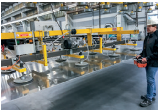
VacuBoySystem VBS-4000KG Systembau-Traverse für das horizontale Handling von Blechen bis 8.000 mm Länge.
