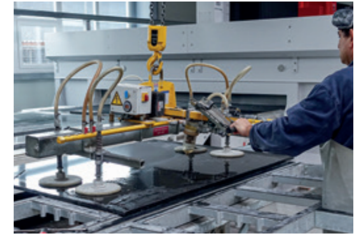
VacuBoy VB-250KG Beschaffen einer Nass-Schleifmaschine mit Steinplatten mittels akkubetriebenen Vakuumheber.
