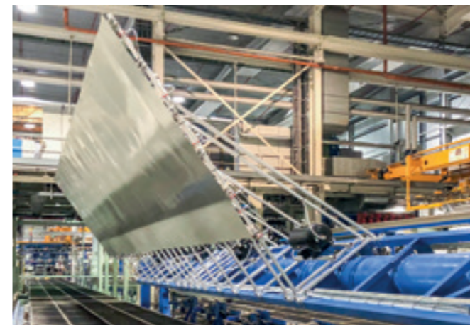
VacuStation SWS-180E-250KG Stationäre Wendestation für Bleche bei der Produktion von 13.000 mm langen LKW Seiten- und Dachelementen.
