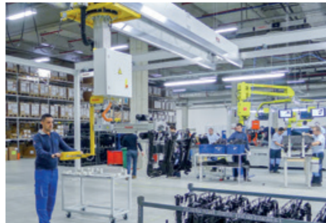
Aluminium-Hängebahnsystem HBS-DB-125KG Mit Doppelbrücke und starrem Hubsystem Liffix für das Umsetzen von Sitzgestellen.
