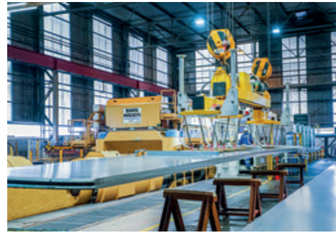
VacuGiant VG-TEL-4000KG Elektromotorisch ausziehbare Vakuumtraverse zum Beschicken einer Reckbank.
