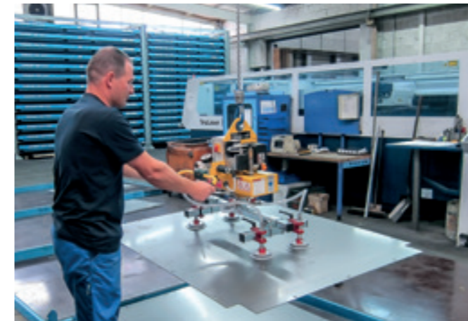
VacuBoyMini VBM-ACCU-125KG Netzunabhängiger Vakuumheber mit Akku-Betrieb für kleinformatige Bleche.
